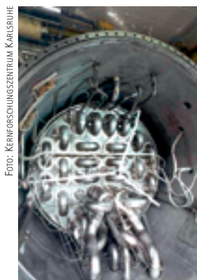
Praktischer Versuch: Im Karlsruher Dynamo-Experiment wird flüssiges Natrium durch ein Röhrensystem gepumpt, um einen Geodynamo künstlich zu erzeugen.
