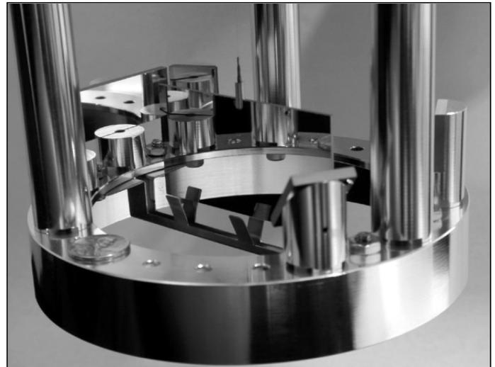
Abb. 5: Detail-Foto der an der Universität von Washington in Seattle zur Hochpräzisions-Messung von  $G$  eingesetzten Drehwaage. Gezeigt ist das an einem Torsionsfaden aufgehängte, im Wesentlichen zweidimensionale rechteckige Pendel. Ein Penny verdeutlicht die Größenverhältnisse.
